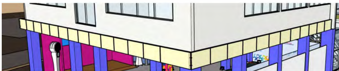
Item 43 - Paineis de LED linear/perimetral, medindo aproximadamente 40,00 m lineares x 0,45 m de altura, totalizando
